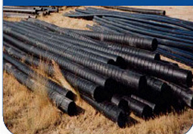
Ranurado de Tuberías Notched Pipes
